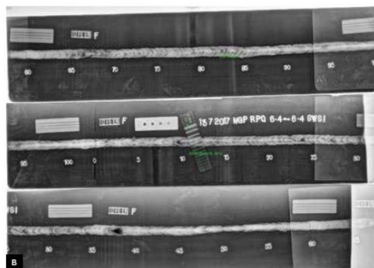
A. Płyta obrazowa owinięta wokół spoiny B. Obraz spoiny rurociągu otrzymany ze skanowania CR
