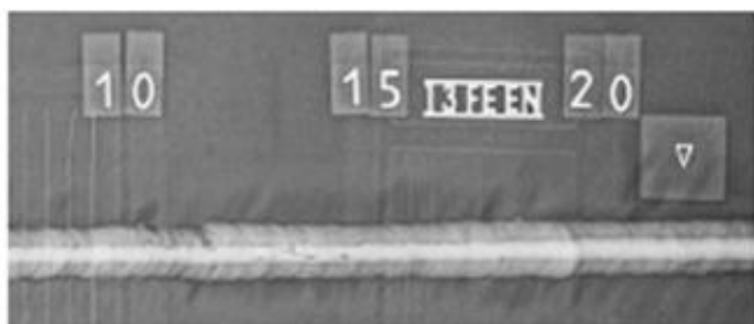
DXR Flex: FE 10 mm – technika SWSI, RTG ISO 17636-2 | Klasa B | Obsługiwany przez Flash!
